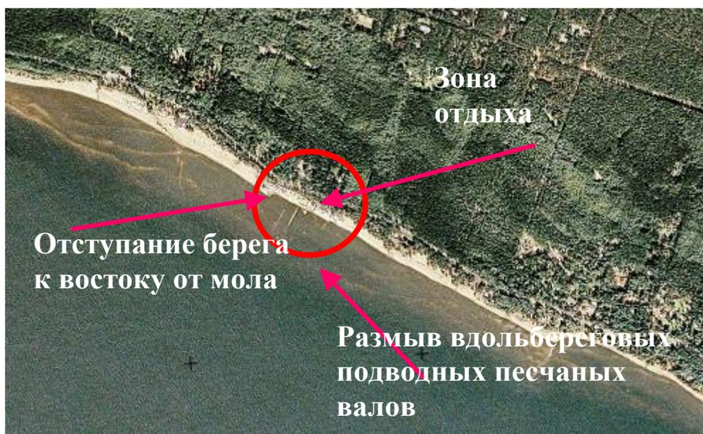
Рис.27. Отступление берега в пределах зоны отдыха в Комарово, вызванное неграмотными мерами по берегозащите.
