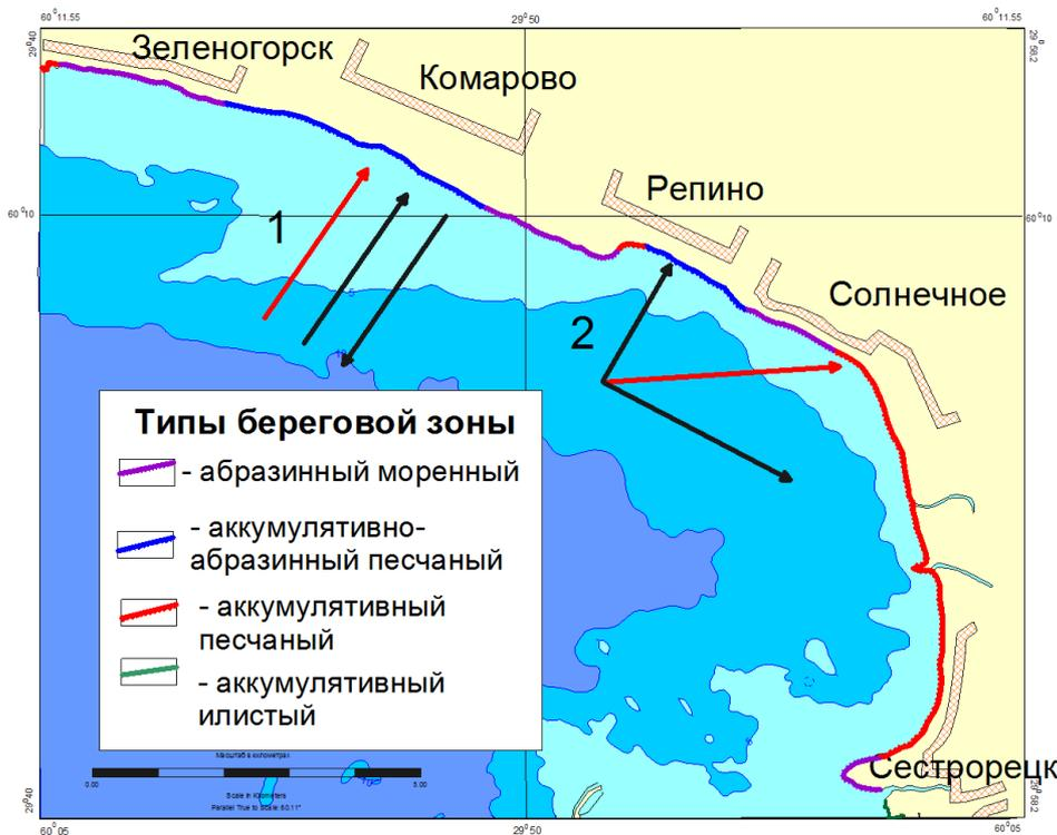
Рис.14. Схема типов берегов Курортного района от Зеленогорска до мыса Дубовской и направления перемещения наносов (черные стрелки) при подходе волн (красные стрелки) под прямым (1) и острым (2) углом к берегу.
